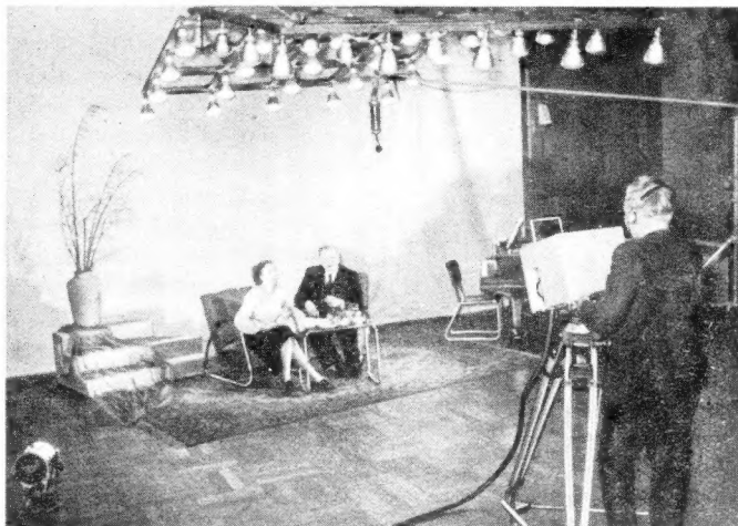
Blick in das Berliner Behelfs-Fernseh-Studio des NWDR. Zur Ausleuchtung der Spielfläche dienen Oberlichter (Philips Speziallampen) sowie eine Reihe von kleinen und großen Scheinwerfern; vorn rechts eine Fernsehkamera (Foto NWDR)
